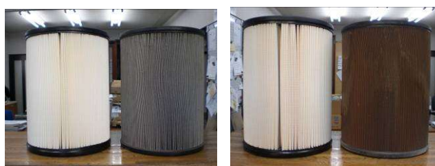
真っ黒で汚れが取れない状態（交換が必要です）
